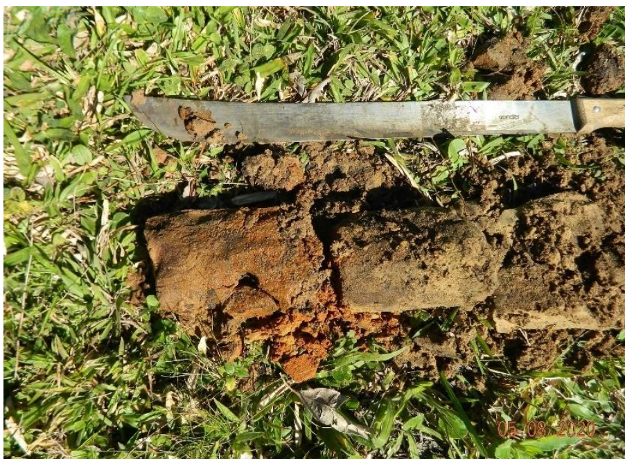
Figura 12. Sedimento interceptado na sondagem ST#20 em depósito praial marinho do Pleistoceno.
